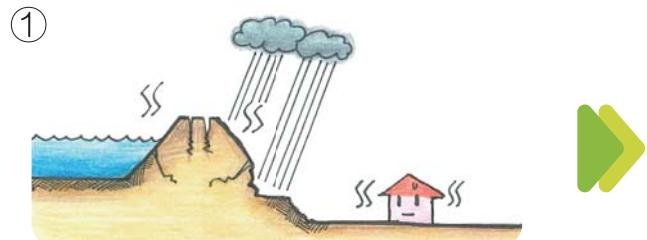
大雨や地震、上流からの土砂や流木の流入等により堤体が破損する。
