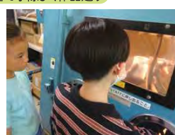
コップに貼り付けた絵をカットニング 機械で粒砂を吹き付けると切り抜いた部分がすりガラス状に色変わり
