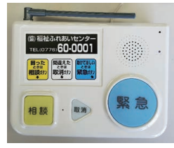
▲緊急通報装置 本体機器
