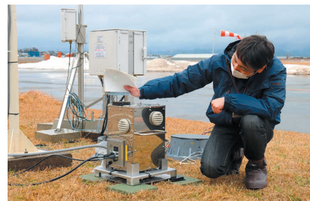
▲レーザーを照射し計測する、雪氷モニタリングセンサ。来年度は同センサを滑走路近くに埋設予定
