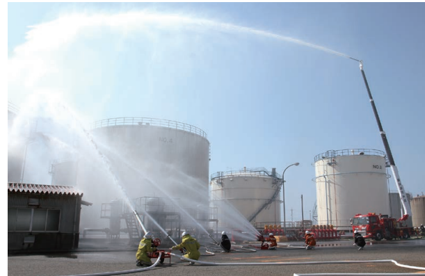
▲22mの高さから放水ができ、最大射程距離が70mの大型化学高所放水車(右)を、今年から訓練に導入
