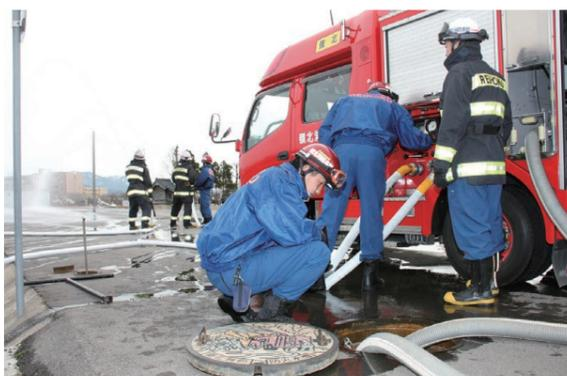
▲放水に必要な水の量が、吸水槽へ十分に供給されるかを確認。毎分約1,400ℓの放水にも対応
