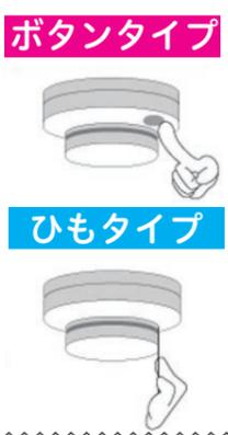
②作動確認を行っても、反応がない場合は本体の故障か電池切れが疑われます。故障か電池切れが分からないときは、取扱説明書を確認するかメーカーにお問い合わせください。
