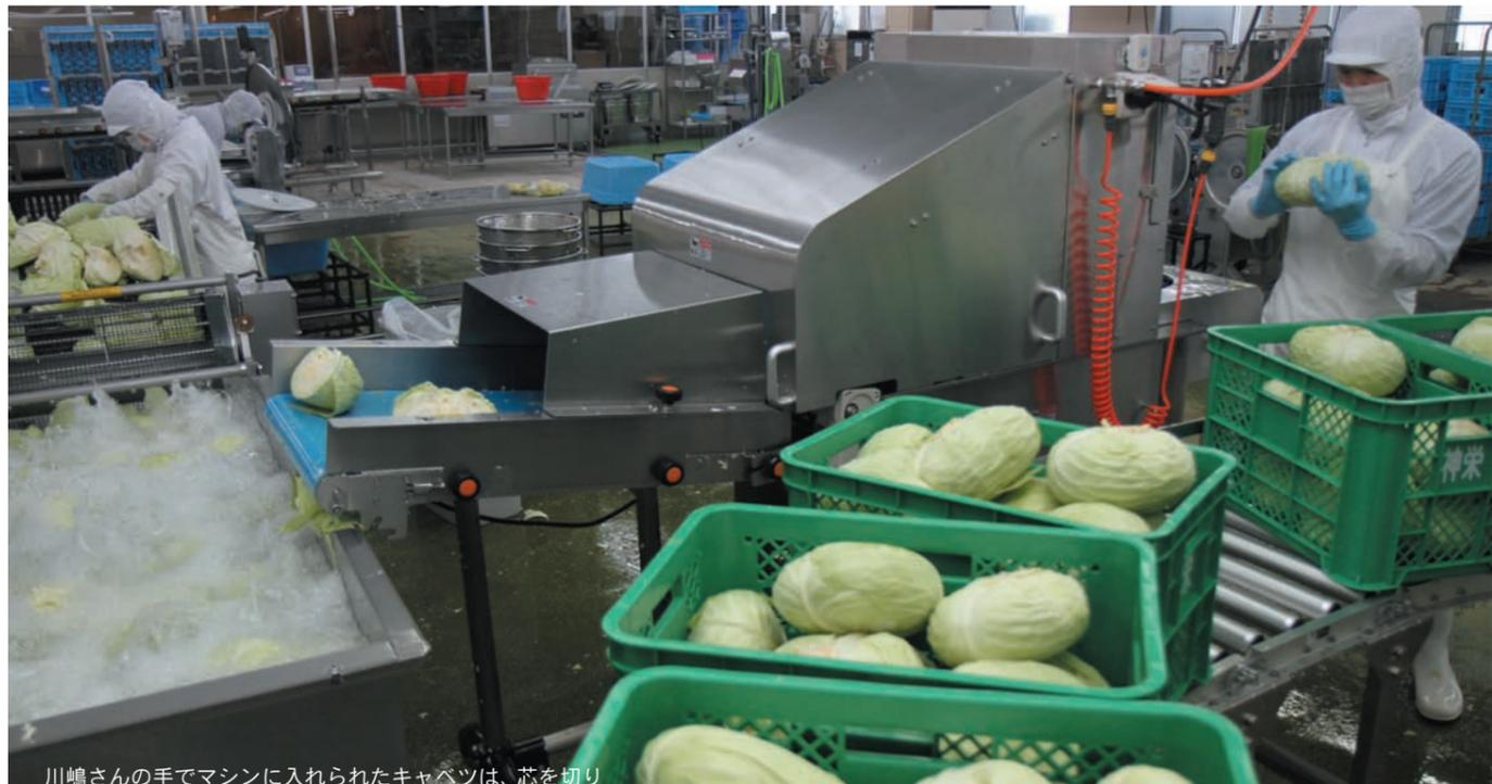
川嶋さんの手でマシンに入れられたキャベツは、芯を切り抜き半分カット、オゾン水洗浄を経て細かくカットする工程へ。いろんな持ち場が連携しながら流れ作業が続く。
