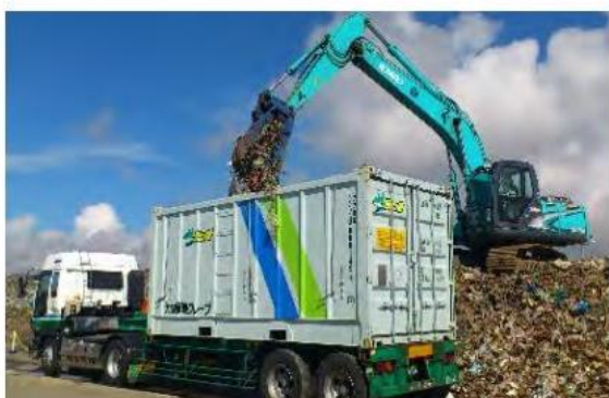
仮置場での海上コンテナへの積込
