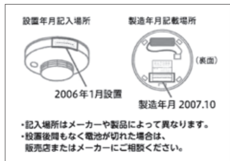
▲住宅用火災警報器の確認箇所
