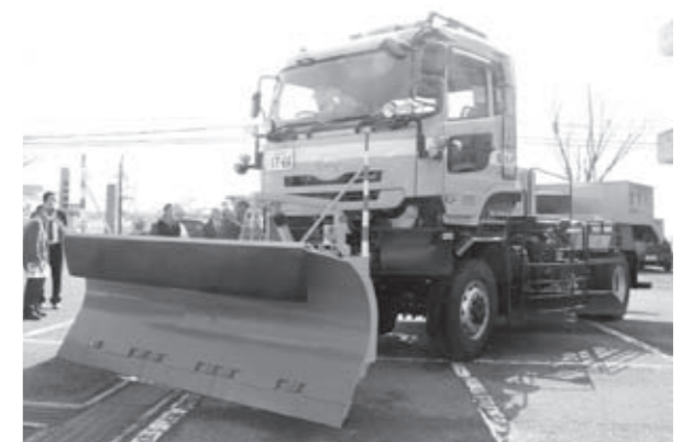
▲新たに導入した大型除雪トラック
