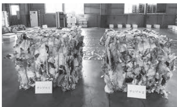
▲本市のプラごみ一括回収においてペール化（圧縮梱包）された再資源化前状態（福井市にあるプラ再生施設）
