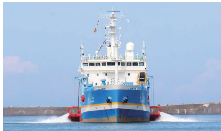
▲「白山」の船体両側にある油回収装置は、海水をジェット噴射し、水の壁を作ることで、油をかき集めながら回収することができる
