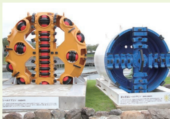
▲地盤に応じたシールドマシンを使って、パイプラインのトンネルを作っていた (左側が岩掘削用、右側が粘性土掘削用)
