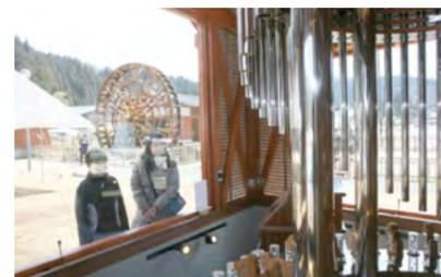
▲チャイムは真ちゅう製のパイプをハンマーで叩き、メロディーを演奏する仕組み
