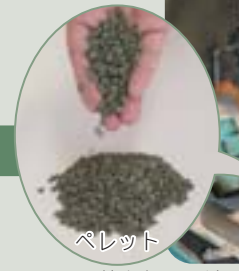
▲さらに熱を加えて溶かし、ペレットというプラスチック製品の原料となるものに加工します
