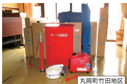
▲消火栓ホース、格納庫、発電機など防災資機材
